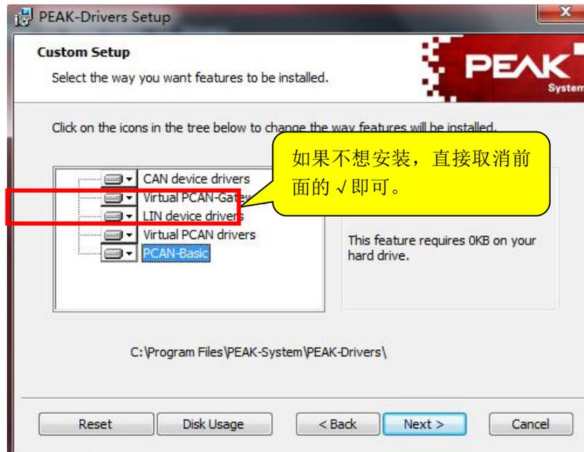
另外，这里的 Virtual PCAN-Gateway 是用与支持 CAN 转以太网或者 CAN 转 Wifi 设备的；LIN device drivers 是 PCAN-USB Pro FD 的 LIN 部分驱动。
