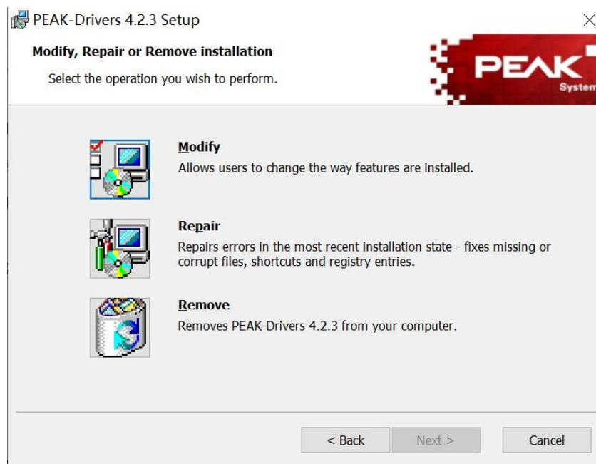
③然后会出现下面这个页面，**注意：**在安装驱动的过程中您可以根据需要选择需要安装的，如下图，如果是用 PCAN-USB 的话，可以选择 CAN device drivers 和 Virtual PCAN drivers，PCAN-Basic 是 PCAN 的二次开发包，也可以选上。
